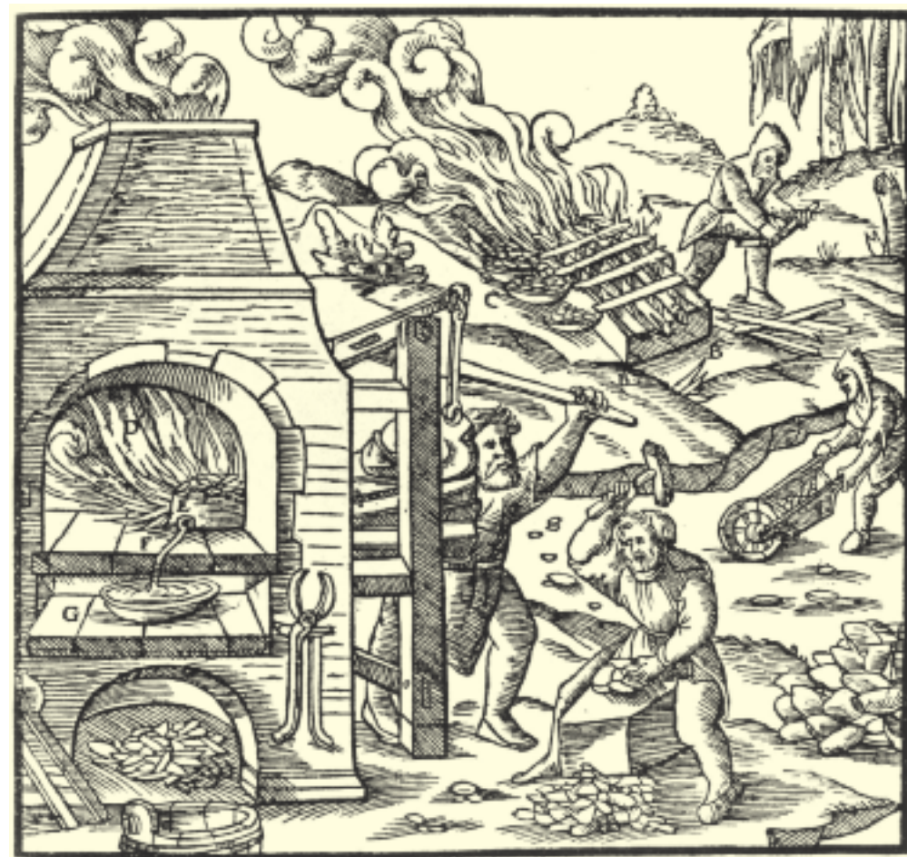
Wytop kruszców. Widoczne są poszczególne etapy tej pracy: transport, rozbijanie, prażenie, wytop. Ilustracja z dzieła De Re Metallica libri XII , autorstwa Georgiusa Agricoli
